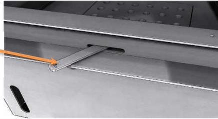
Registre d'air (Position 2) : la position du registre en position 2 permet d'obtenir un fonctionnement performant et une combustion propre. Nous vous recommandons de maintenir ce registre dans cette position afin de favoriser le balayage de la vitre. L'action de fermeture plus importante de ce registre n'est justifiée que si les tirages sont plus élevés que ceux qui sont recommandés. Dans ce cas, ce registre peut être partiellement refermé pour obtenir un fonctionnement satisfaisant.
