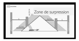
De plus, que l'installation soit en configuration séparée ou concentrique, en plus des généralités qui précèdent, le terminal vertical ne doit pas se trouver à proximité des ouvrants ou entrées d'air, des obstacles ou des façades des habitations voisines (les zones hachurées dans les schémas ci-dessous sont les zones interdites) :
